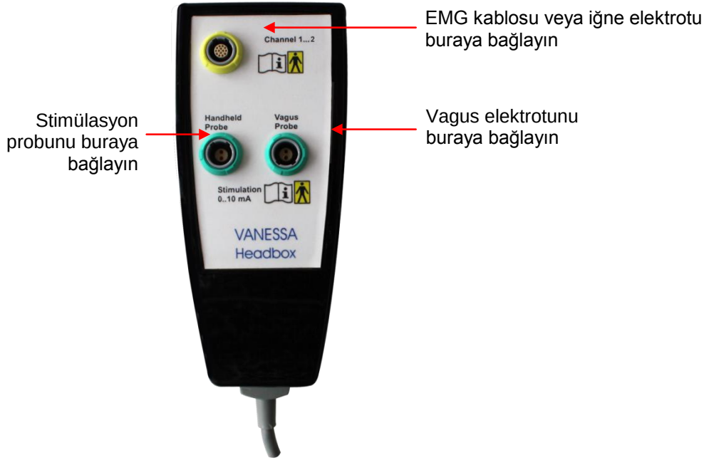
Şekil 44 VANESSA Bağlantı kutusu bağlantıları (Madde No.: 21-0016)
